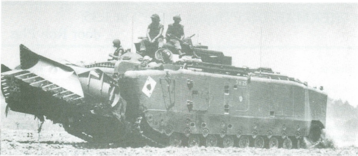
Een LVTE, uitgerust met een ploeg voor het ruimen van mijnen
